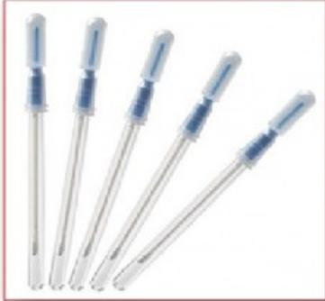
Reattivo predosato ULTRASNAP per test su superfici, da utilizzare con il Bioluminometro System Sure Plus. I reattivi predosati evitano all'operatore di dover utilizzare pipette o flaconcini e permettono un'ottima ripetibilità delle misure. Possono essere conservati fino a 12 mesi in frigorifero o 1 mese a temperatura ambiente.
