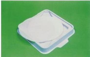
Membrane in acetato di cellulosa Ø 47 mm. porosità 0,2 µm conf.100
