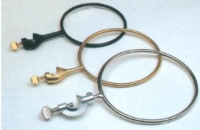
Sostegno ad anello gambo con morsetto in ferro verniciato Ø mm 50
