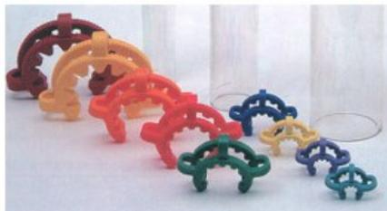
Pinza Keck per raccordo conico modello KC 12
