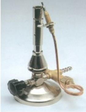
Lampada Bunsen Teclu Sekur-flam stabilizzatore fiamma e rubinetto, rondella regolazione aria e valvola sicurezza diam.x h. mm 16x175
