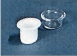
Capsula per bomba di Mahler in quarzo trasparente con bordi  $\varnothing$ xH 22X20 mm
