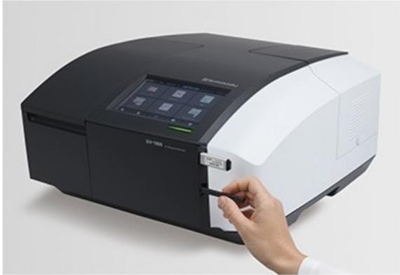
Spettrofotometro a doppio raggio SHIMADZU modello UV-1900i
